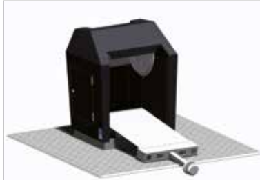
Système de préhension à crochet unique.
