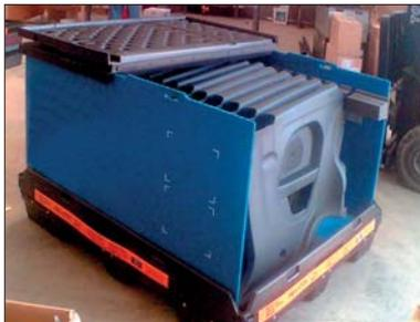
**Palettes à parois démontables en plaque cannelée et couvercles en combinaison avec un intérieur en mousse pour maintenir en place des pièces automobiles.**
