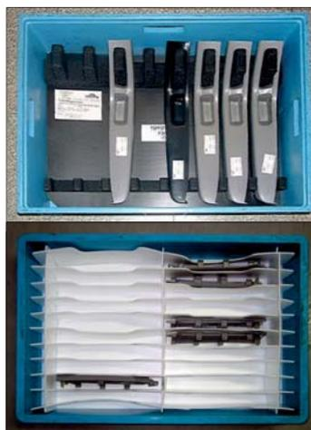
**Le moulage sous vide est une méthode qui permet de transformer une plaque plastique en produit comme un porte-produits. Cela peut être fait sur mesure avec une grande précision. Le moulage sous vide est généralement rentable à partir d'une série de 250 pièces.**
