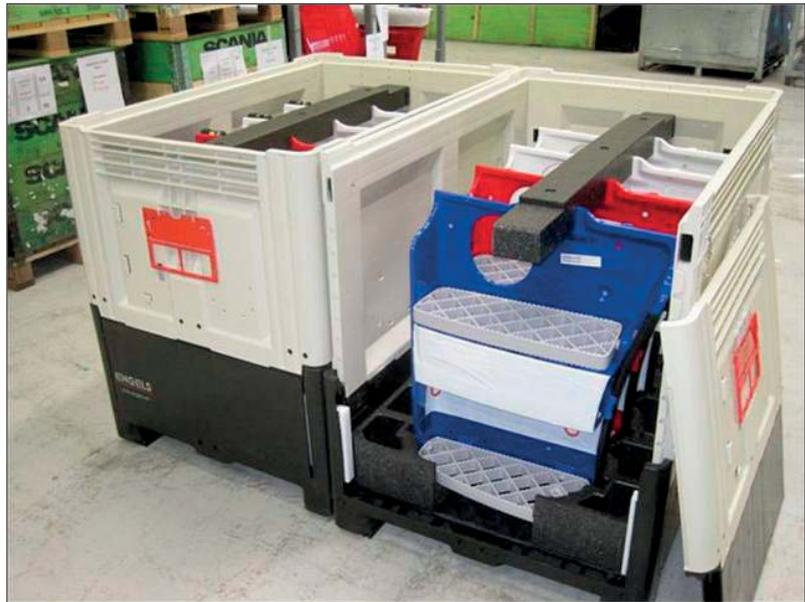
*Smartbox utilisé pour des "insteps". L'originalité de ce Smartbox est l'avant entièrement amovible pour simplifier la manipulation des 'insteps'. Ces 'insteps' sont maintenus en place par des intérieurs en mousse EPP faits sur mesure.*
