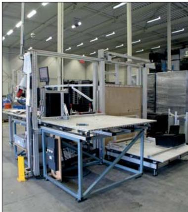
**Machine à souder au miroir pour le soudage de produits plastiques jusqu'à 1200 mm.**
