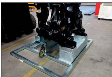
**Un porte-produits fabriqué entièrement en acier pour une pièce d'un engin agricole. Le porte-produits est adapté pour être utilisé en combinaison avec un Smartbox.**
