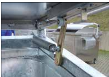
Der Deckel bleibt durch die Federmechanik offen.
