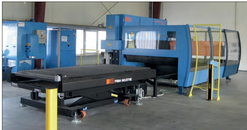
Herzstück unserer Produktion ist die 4000-Watt-Laserschneidanlage
