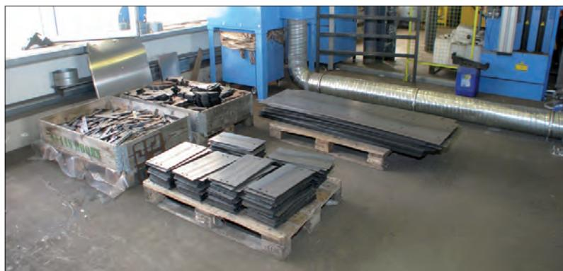
Teile werden mit dem Laser geschnitten. Schnell und präzise.
