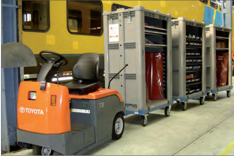
Ausführung mit Zugtangensystem. Im Einsatz bei NedTrain für den Service für Personenzüge. Durch den Kunststoff kann der Inhalt mit RFID-Lesern gescannt werden.
