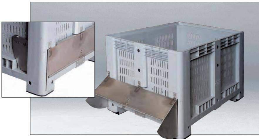
Palettenbox für die Verwendung im Landbausektor. Diese Palettenbox wird zum Waschen von Gemüse verwendet. Um das Leeren zu vereinfachen, wurde an der Seitenwand eine Klappe aus Edelstahl angebracht.
