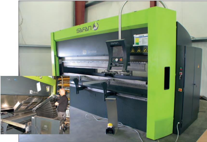
Unsere moderne Kantbank arbeitet mit einer CNC-Steuerung. Selbst komplizierte Biegearbeiten werden in der Einzel- und Serienproduktion mit hoher Präzision ausgeführt.
