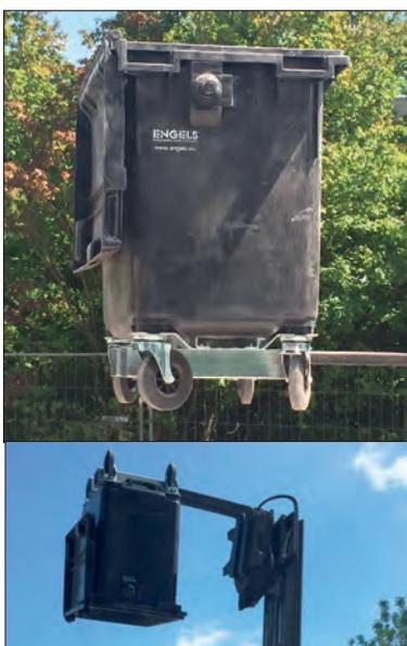
Mittels Metallstreifen am Behälter und Magneten am Deckel erzielen wir eine feste Arretierung des Deckels im geöffneten Zustand.
