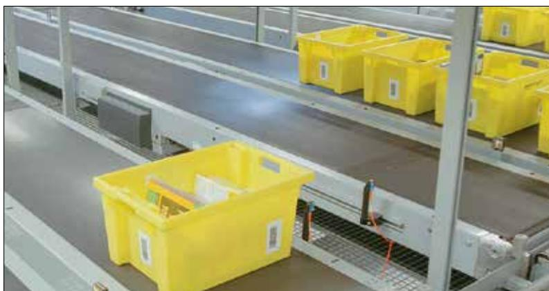
Bacs à fond renforcé sur un système de tapis roulant pour la distribution de livres et CD. (Photo : Vanderlande Industries.)
