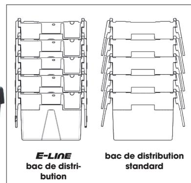
La spécificité du bac de distribution *E-LINE* est que les moitiés de couvercle ouvertes se replient contre les parois des bacs lors du transport retour. Les bacs restent ainsi dans les limites d'une palette Iso. Il y a ainsi nettement de moins de risque de dommages aux couvercles et moins d'espace est perdu entre les bacs.
