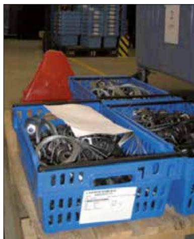
Pour optimiser le transport des produits de l'entrepôt vers les différentes chaînes de production, Gazelle a opté pour un nouveau système avec bacs de distribution à barres de gerbage en plastique.
