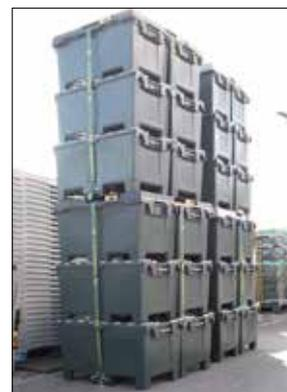
Les bacs de grand volume avec couvercles à charnières (navette) sont notamment utilisés pour protéger le contenu contre le vol pendant le transport. Charge maximale (statique) de gerbage : 450 kg, par pièce charge maxi 100 kg.
