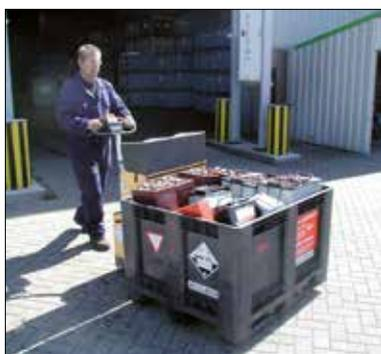
Ses patins renforcés et ses parois droites permettent de basculer facilement la caisse pour la vider. Généralement avec couvercle amovible. Modèle et autocollants conformes à la réglementation ADR. En dimension : 1200 x 1000 x 780 mm.
