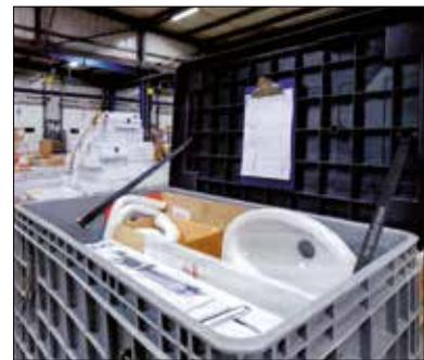
**Bacs de grand volume utilisés dans le secteur de la construction. Les bacs sont remplis avec tous les matériaux nécessaires pour une tâche spécifique. Cela améliore la logistique, augmente l'efficacité et réduit les stocks.**
