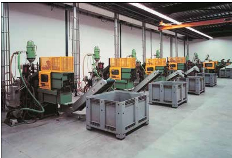
Caisses-palettes en usage dans une usine de moulage par injection.
