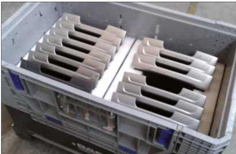
Caisses-palettes avec un intérieur sur mesure de plaque cannelée et de mousse pour élément intérieur de cabine de camion.
