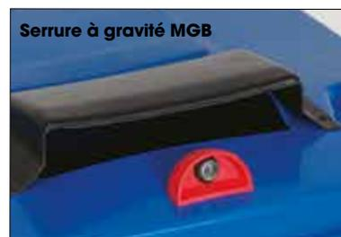
Avec les serrures à gravité MGB, le couvercle est déverrouillé automatiquement lorsque le MGB est incliné à plus de 90°. Quand le conteneur est ensuite redressé, le couvercle est à nouveau verrouillé.
