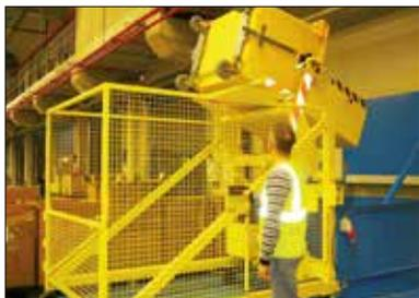
**Les conteneurs à 4 roues conviennent pour le vidage dans une installation de basculement.**
