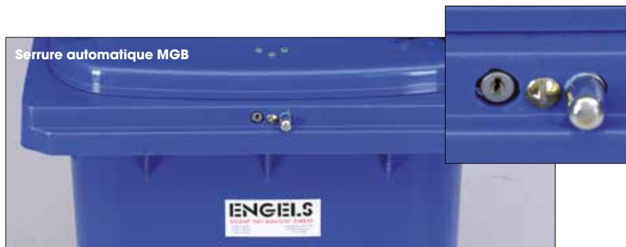
Avec la serrure automatique, le couvercle du conteneur s'ouvre quand le conteneur est suspendu au camion pendant la préhension frontale. Avec la pression contre la broche, le couvercle s'ouvre. Pour le remplissage du conteneur, l'utilisateur a accès à l'aide de la serrure cylindrique.
