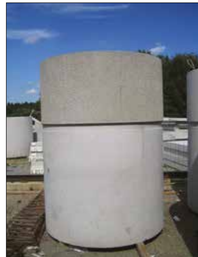
Cuve en béton en 2 parties. Qualité de béton C30/37 XC4, résistant aux nappes phréatiques.
