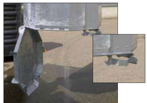
Le bac intérieur en acier avec une seule trappe est vidé à l'aide du système à 1 crochet avec crochet spécial.
