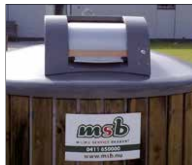
Tièrso avec tambour verrouillable à Vught. Serrure cylindrique identique à l'accès au complexe résidentiel.
