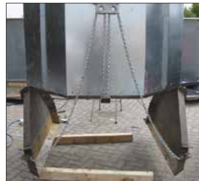
Double trappe de fond, qui peut être ouvert de manière contrôlée. L'intérieur du conteneur avec double trappe ne comprend pas de pièces mobiles du système de commande.
