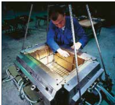
Moule à injection : extérieur des pièces de formage d'un bac Eurotec.
