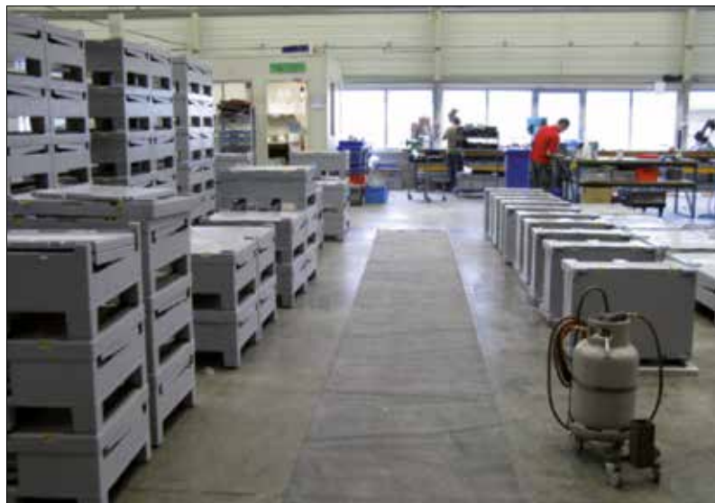
Comme les bacs doivent être imprimés des deux côtés, un rail est créé pour y faire sécher les bacs.
