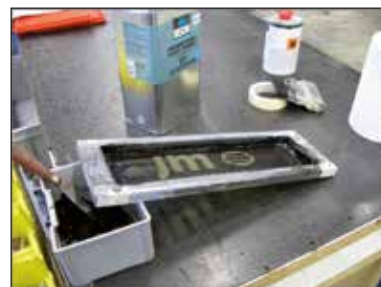
Le tamis est nettoyé à fond afin que l'encre puisse être répartie de manière uniforme.
