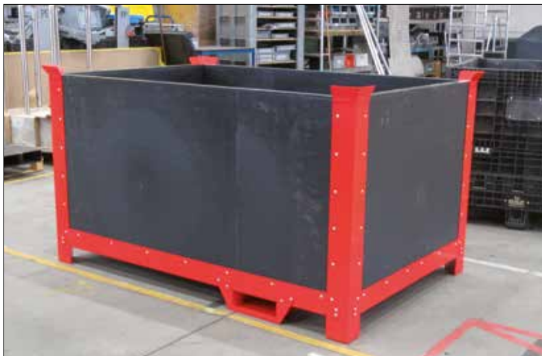
Bac de rétention « silencieux » pour pièces résiduelles en acier, constitué d'un cadre métallique et de panneaux en plastique. Conçu pour Volkswagen.
