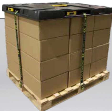
Le couvercle est muni de sangles entièrement intégré avec mécanisme à cliquet. Le Clever lid est disponible avec 2 ou 4 sangles. Les sangles sont remplaçables ou échangeables sous forme de cassette.
