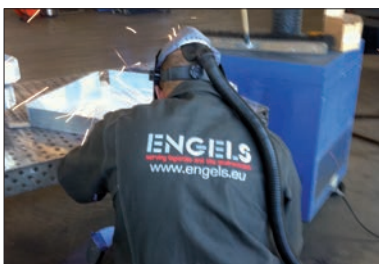
Soudage de l'aluminium. Beaucoup de nos produits sont fabriqués en aluminium en raison de sa légèreté et de sa bonne résistance à la corrosion.
