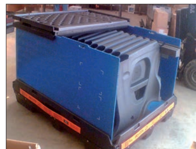
Caisse-palette avec parois démontables et un calage en mousse pour des pièces automobiles.
