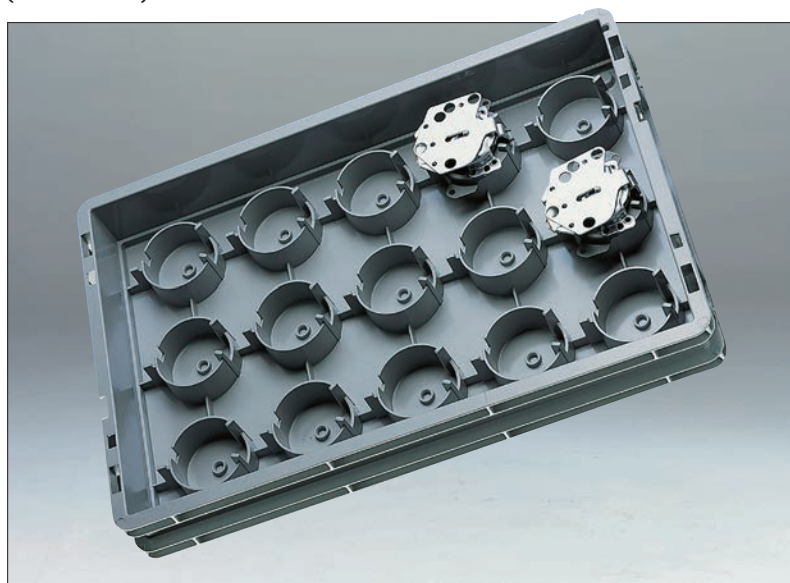
Support de pièces standard 400 x 300 mm. La forme de l'extérieur est constante, tout comme l'empilabilité sur d'autres supports de pièces. Seul l'intérieur est réalisé sur mesure.
