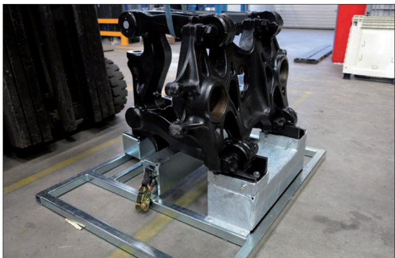
Un support fabriqué entièrement en acier pour une pièce d'un engin agricole. Le support est adapté pour être utilisé en combinaison avec une Smartbox.
