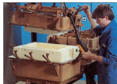
Après refroidissement, le produit creux est retiré du moule.
