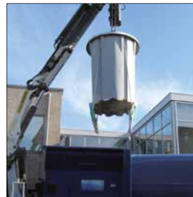
Vidage à l'aide d'une préhension 3 crochets.
