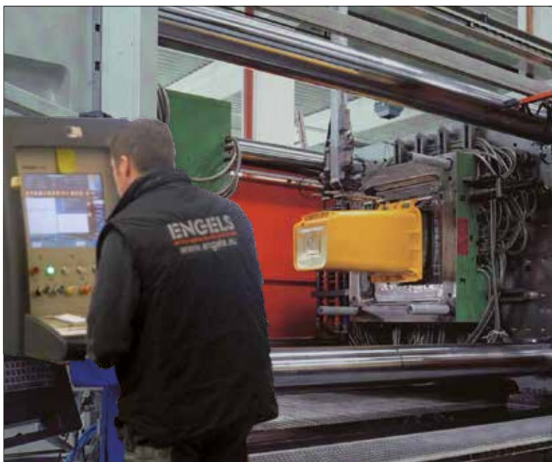
Machine de moulage par injection pour conteneurs de 240 litres ou bacs de grand volume.
