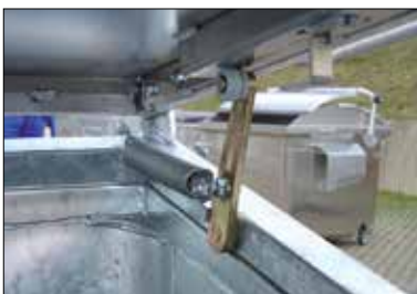
Le couvercle reste ouvert grâce au mécanisme à ressort.
