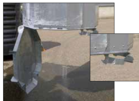
Le bac intérieur en acier avec une seule trappe est vidé à l'aide du système à 1 crochet avec crochet spécial.
