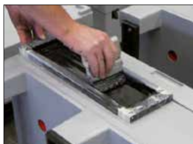
Le tamis est posé sur le bac et, en un mouvement de pression, l'encre est appliquée sur le bac.
