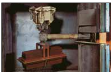
Le bras tourne dans le four et, à leur tour, les moules tournent autour du bras.
