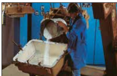
Le moule est rempli puis fermé.
