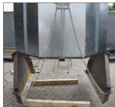
Double trappe de fond, qui peut être ouverte de manière contrôlée. L'intérieur du conteneur avec double trappe ne comprend pas de pièces mobiles du système de commande.
