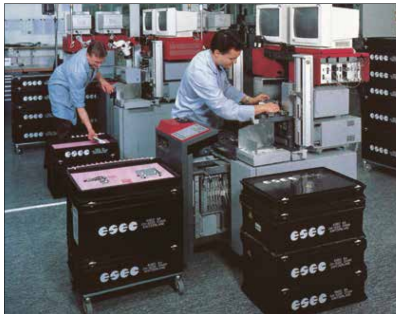
Dans un environnement ESD, non seulement les bacs, mais aussi le sol, les chaussures, les postes de travail et les véhicules sont conducteurs !
