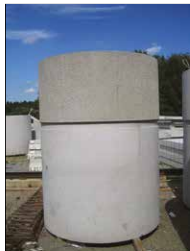
Cuve en béton en 2 parties. Qualité de béton C30/37 XC4, résistant aux nappes phréatiques.
