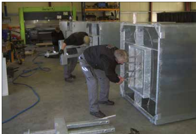
Assemblage de conteneurs à déchets enterrés.
