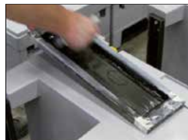
Le tamis est retiré du bac et l'encre revient à la position initiale du tamis.
