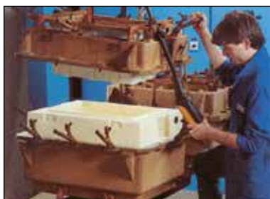
Après refroidissement, le produit creux est retiré du moule.
