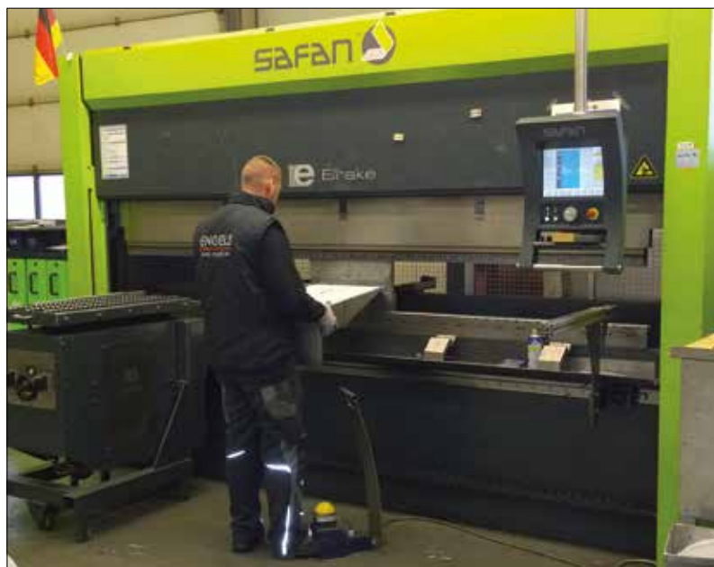
Notre plieuse moderne fonctionne avec une commande CNC. Même des travaux de pliage en lots ou pour la production de masse sont réalisés avec une grande précision.
