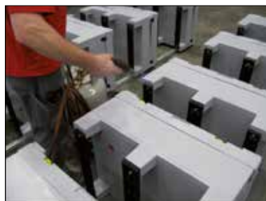
Les bacs sont flambés afin que l'encre continue à bien adhérer au bac.
