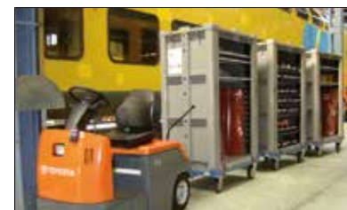
Version avec système d'attelage. Utilisées chez NedTrain pour la prestation des services dans les trains de voyageurs. À travers le plastique, le contenu peut être contrôlé par des lecteurs RFID.
