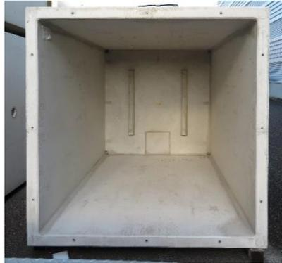
Le silo correspond à une classe de résistance mécanique C45/55. Les calculs statiques démontrent que le silo ne peut pas s'élever du sol sous l'effet de la pression des eaux souterraines. Cela veut dire qu'il n'y a jamais besoin d'un ancrage à la base du silo béton. La fabrication est conforme au DIN 13071.
